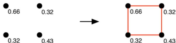
On trouve que **chaque arête de la cellule possède une intersection** avec l'isocontour si  $v = 0.37$ .
